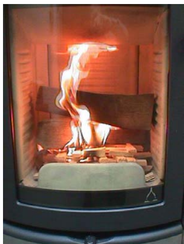
Fig. 5 : Fermeture du coulisseau d'entrée d'air primaire
