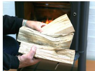
6. Der lægges 2-3 stykker brænde à ca. 0,5 kg og ca. 25 cm lange ind over gløderne i ét lag med en afstand på ca. 1 cm mellem træstykkerne.
